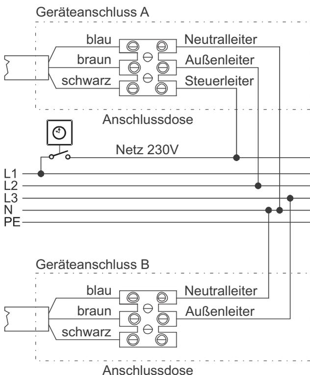
Wird der schwarze Leiter nicht verwendet, ist er an eine elektrisch isolierte Klemme anzuschließen und nicht an das Stromnetz.
