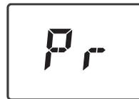
Nach Konfigurieren des 3. Zeitfensters wird **Pr** im Display angezeigt.
