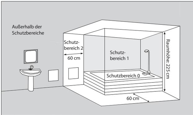
Das Gerät kann in Schutzbereich 2 oder außerhalb der Schutzbereiche aufgestellt werden.
