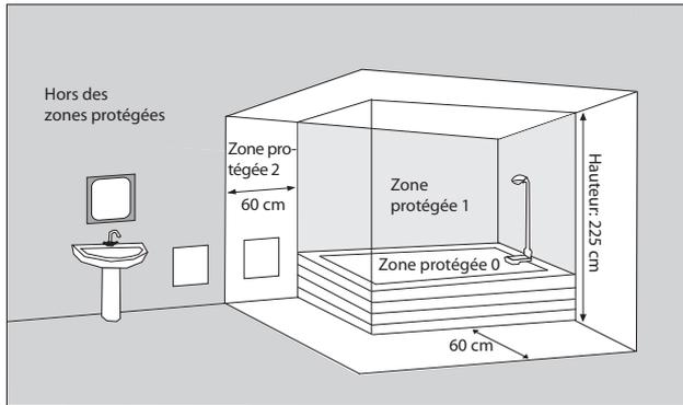
L'appareil peut être installé en zone protégée 2 ou hors des zones protégées.
