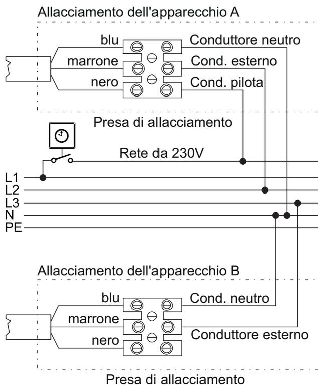
Qualora si decida di non utilizzare il conduttore nero, è necessario collegarlo a un morsetto isolato elettricamente e non alla rete elettrica.
