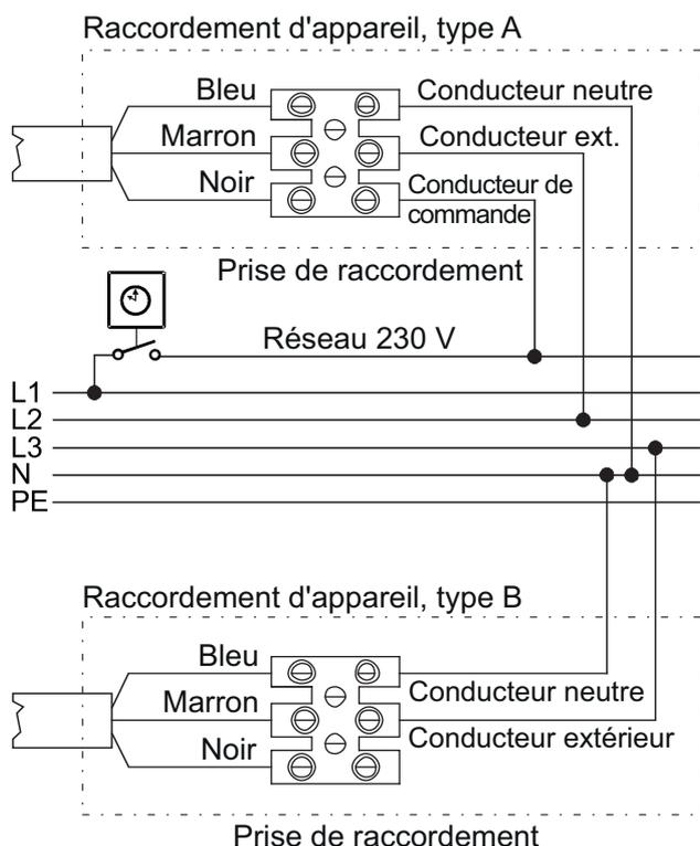
Si le conducteur noir n'est pas utilisé, il doit être relié à une borne isolée électriquement, et non pas au réseau électrique.
